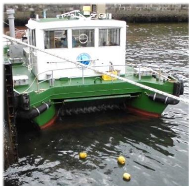
前方から浮き(ゴミ)を吸う
